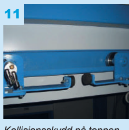
11 Kollisionsskydd på toppen av masten (vid mer än en WALL-MAN® på skenan).
