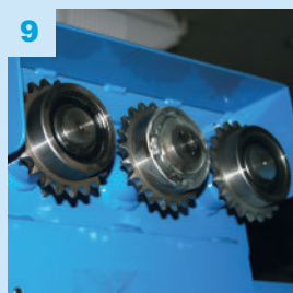
9 Kedjedrift – när den övre skenan är hal
